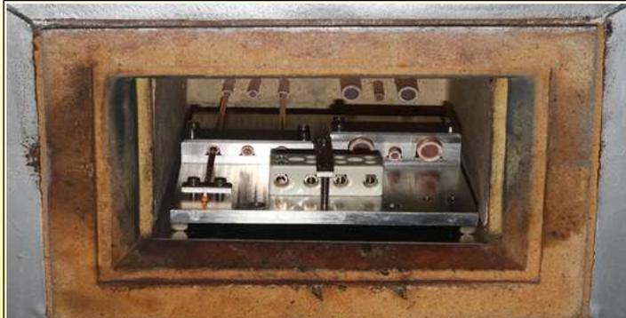
Horno de prueba para determinar la resistividad de la cerámica en función de la temperatura (laboratorio Ultimheat)
