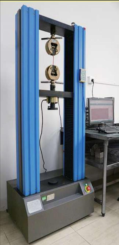
Banco de pruebas para ensayos de tracción
