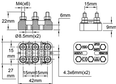
**Modelo 10A 450V (espaciado de terminales 15 mm con tornillos M4)**
