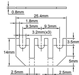
Tres vías, diámetro de paso de 9,3 mm, compatible con la serie BE 2,5 mm<sup>2</sup>.
