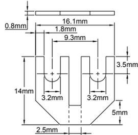
Dos vías, diámetro de paso de 9,3, compatible con la serie BE 2,5 mm<sup>2</sup>.
