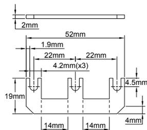
Tres vías, diámetro de paso de 20 mm, compatibles con las series BCA y BCB.
