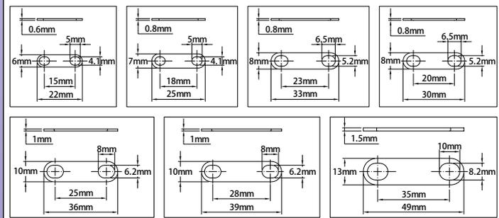
**Puentes de latón para bloques de terminales de motor**
