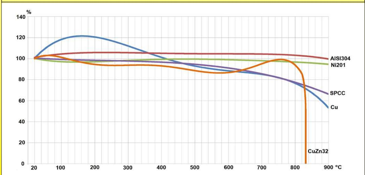
El cobre y el acero pierden de forma gradual su resistencia mecánica para llegar a retener tan solo un 50 % de la misma al llegar a los 900 °C. El latón, sin embargo, permanece siendo relativamente estable, pero alcanza su punto de fusión poco antes de los 900 °C. Las resistencias mecánicas del acero inoxidable 304 y del níquel 201 no presentan variaciones significativas hasta los 900 °C.
