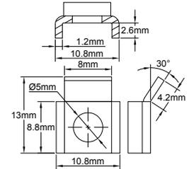
Puente para tornillos M4 con protección anti desgarros, orificio de 5 mm, diseñado para su montaje en bloques de terminales de cerámica de las series BCA y BCB. Incompatible con la serie BCC.
