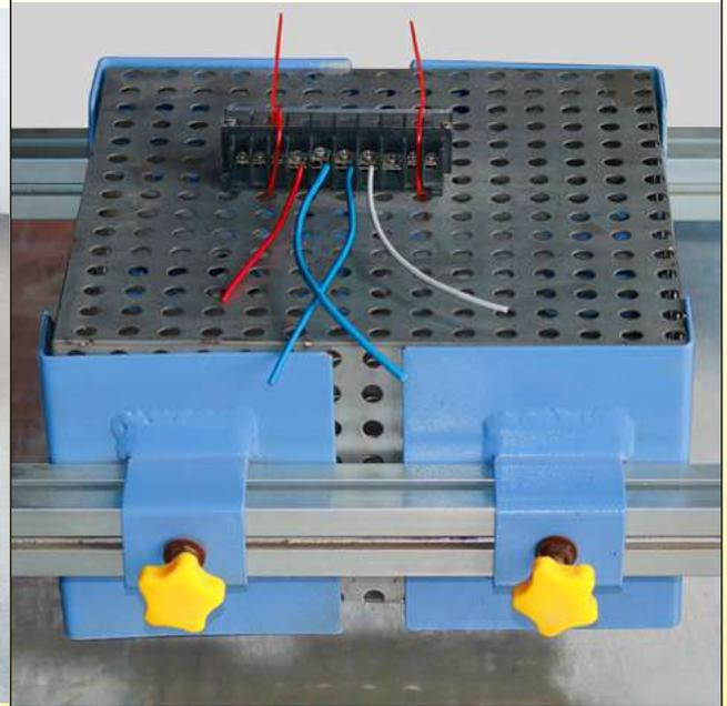
Bloque de conexión durante la prueba
