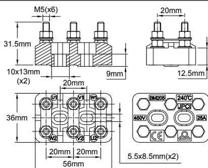
**Modelo 25A 450V (espaciado de terminales 20 mm con tornillos M5)**
