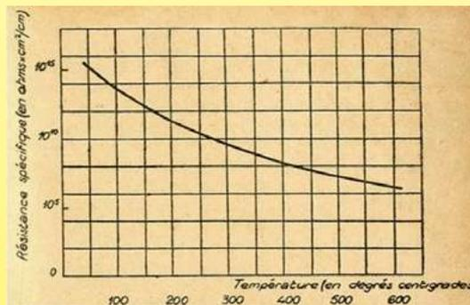
Variación de la resistencia de la porcelana en función de la temperatura indicada en ohmios.cm/cm<sup>2</sup> (curva logarítmica). Cuando la temperatura es de entre 20 °C y 300 °C, su resistencia se divide entre 10.000 (Matériaux electrotechniques modernes de 1945, museo Ultimheat)
