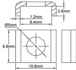
Soporte para tornillos M4, orificio de 5 mm, diseñado para su montaje en los bloques de terminales de las series BCA, BCB y BCC.
