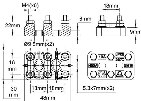
**Modelo 10A 450V (espaciado de terminales 18 mm con tornillos M4)**
